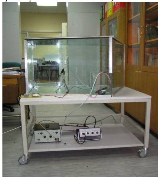
Sl. 3. Prikaz kompletne aparature korišćene u merenjima. U gornjem delu je model reverberacione komore, a u donjem su prateći uređaji.
