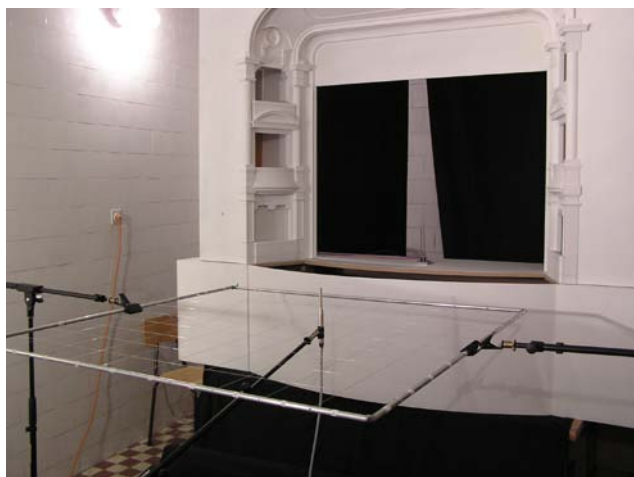
Sl. 1. Fizički model portalnog dela sale opere u Ljubljani sa pozicijama zvučne pobude i prijemnika
