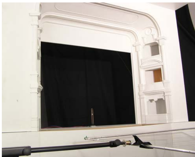
Sl. 2. Fotografija fizičkog modela proscenijumskih loža. Na bini je vidljiv varničar u veličini pevača i ram sa rasterom koji je služio za postavljanje mikrofona na odgovarajuće pozicije.
