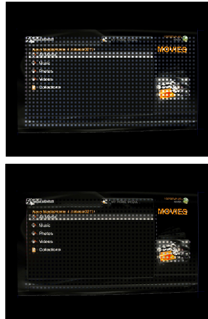
Sl. 6. Regioni poređenja bez normalizacije (gore) i sa normalizacijom (dole). U regionima se nalazi probna slika, a van njih se nalazi referentna slika
